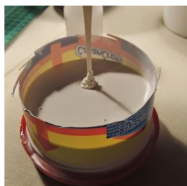
colada de caucho para fabricar molde
