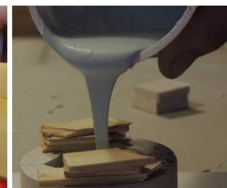
colada de resina ecocryl en molde caucho
