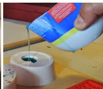
colada de resina poliéster en molde caucho
