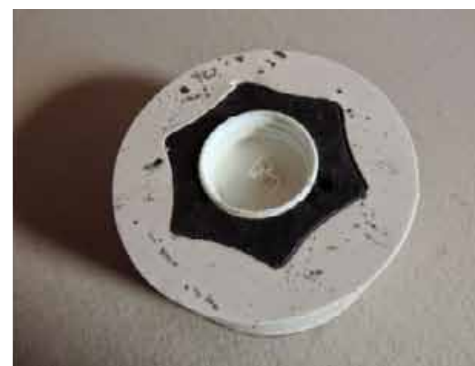
molde de caucho y pieza de resina poliuretánica con tapita inserto para generar textura interior
